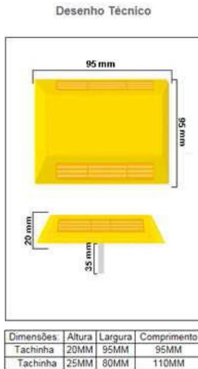
OBS: NA TACHINHA BIDIRECIONAL, EXISTE ELEMENTO REFLETIDO DOS DOIS LADOS DA PEÇA.
