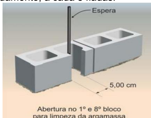
Figura 20: Excesso de argamassa no interior dos blocos para limpeza
