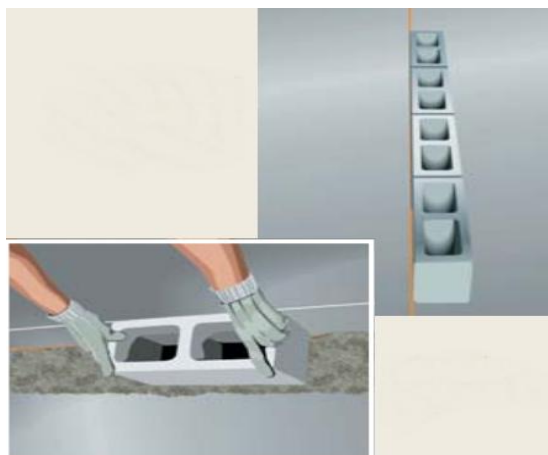
Figura 5: Assentamento do bloco
