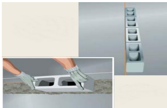
Figura 5: Assentamento do bloco
