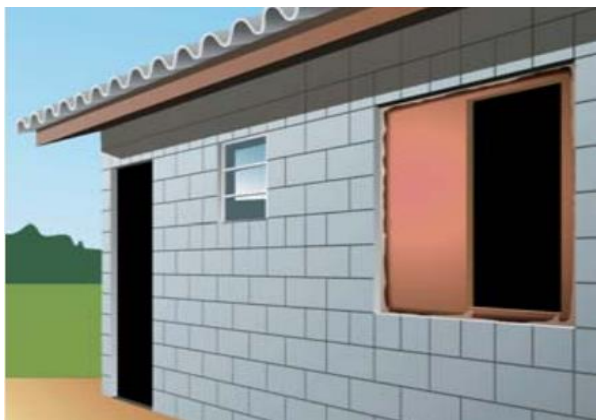
Figura 14: Aplicação de janela com unidade modular compatível com a da alvenaria
