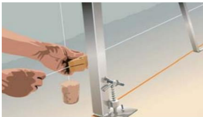
Figura 1: Nivelamento das Fiadas.
