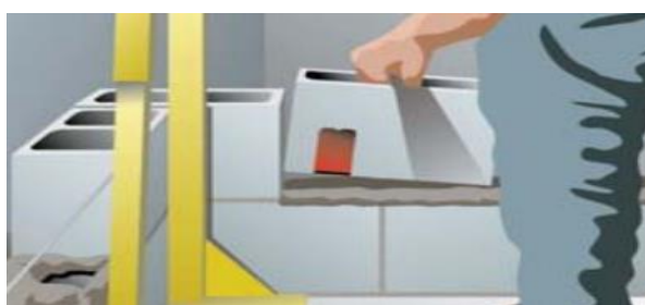
Figura 12: Aplicação das caixas elétricas nos blocos Figura 13: Assentamento do bloco elétrico
