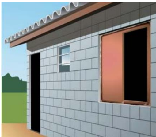
Figura 14: Aplicação de janela com unidade modular compatível com a da alvenaria
