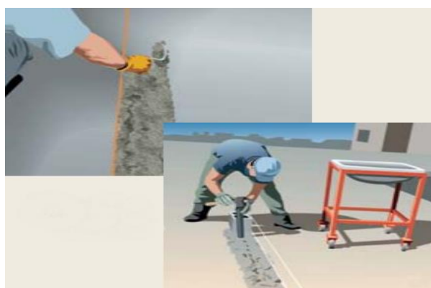
Figura 3: Procedimento para molhar a superfície e Figura 4: Aplicação da argamassa
