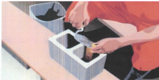
Fig. 12: Aplicação das caixas elétricas nos blocos. Fig. 13: Assentamento do bloco elétrico.
