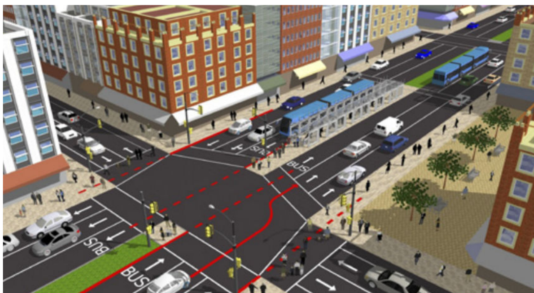
Figura 7.88: Faixas não alinhadas. Fonte: Embarq.
