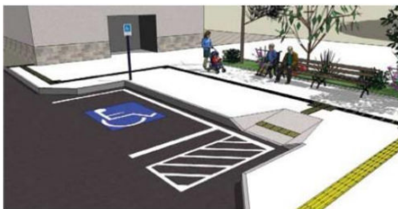
Figura 7.35: Vaga reservada para pessoa com deficiência.
