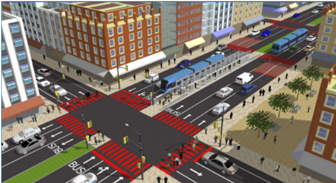
Figura 7.95: Alinhamento da travessia de pedestre para sinalização adequada Fonte: Embarq.
